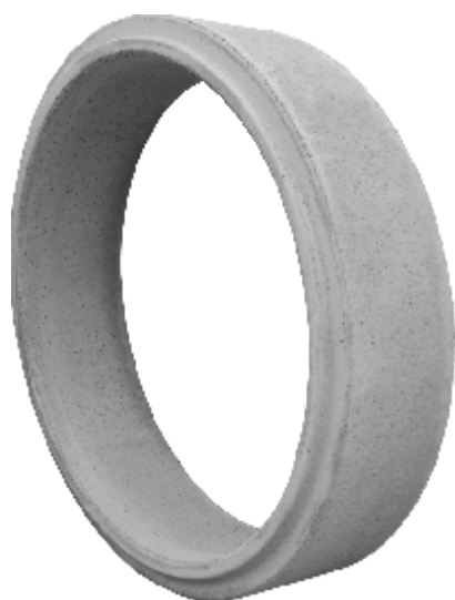
CEV FI 200 50 CM Teža: 1100 kg Cev je minimalno armirana (3 varnostni obroči, 6 pokončnih palic)
