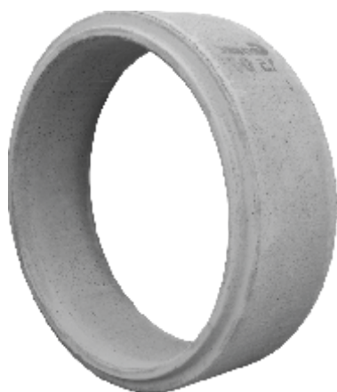
CEV FI 150 Teža: 800kg Cev je minimalno armirana (2 varnostna obroča)
